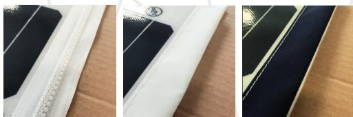
Un lato della cerniera viene cucito sul bordo del pannello, l'altro su qualsiasi tipo di tessuto o telo. Soluzione adeguata a bimini-top in campo nautico e/o tende di qualsiasi tipo. Grande semplicità di installazione e rimozione.
