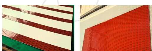
Per una completa e definitiva integrazione dei pannelli fotovoltaici nella superficie di installazione, Enecom propone il biadesivo strutturale in schiuma acrilica. Può essere fornito in strisce di larghezza 50mm/25mm, oppure può essere applicato su tutto il retro della superficie del pannello fotovoltaico. Metodo ideale per installazioni permanenti.
